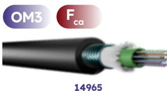
**CABLES FIBRA ÓPTICA ARMADO METÁLICO MULTIMODO OM3 [50/125 μm] PARA EXTERIOR, Fca, ESTRUCTURA HOLLGADA, COLOR NEGRO**
